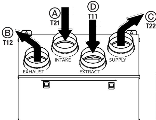
Fig. 7.a Sonde di temperatura QR280E.
