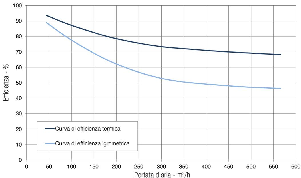
**Fig. 6.e** Dati dello scambiatore entalpico condizioni di prova: Aria interna 25°C 50% UR
