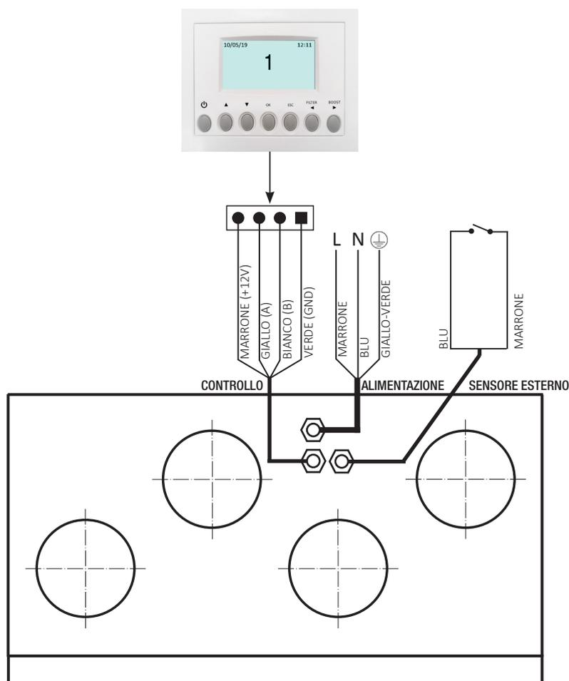
Fig. 5.p Collegamento cavi
